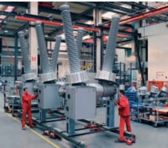
Монтаж выключателя 3AP1DT с отдельным пружинным приводом на каждый полюс
